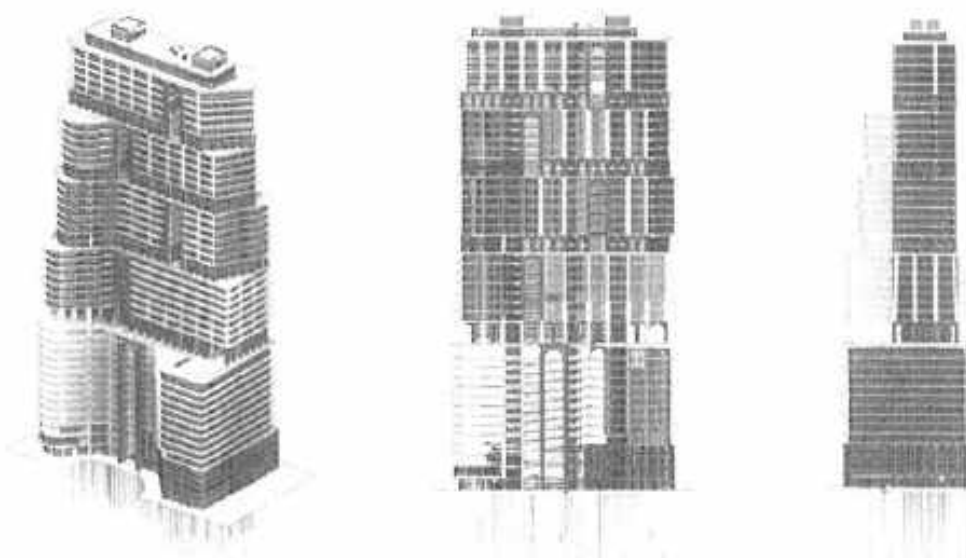
Ilustración 9: Estructuración Proyecto YOO - GYE. Isometría y Modelo matemático.
