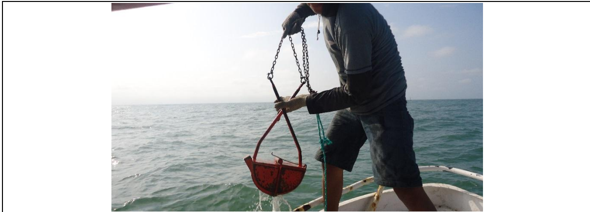
Draga Van Veen, muestreador de sedimento del fondo utilizado en cada una de las veinte estaciones.
