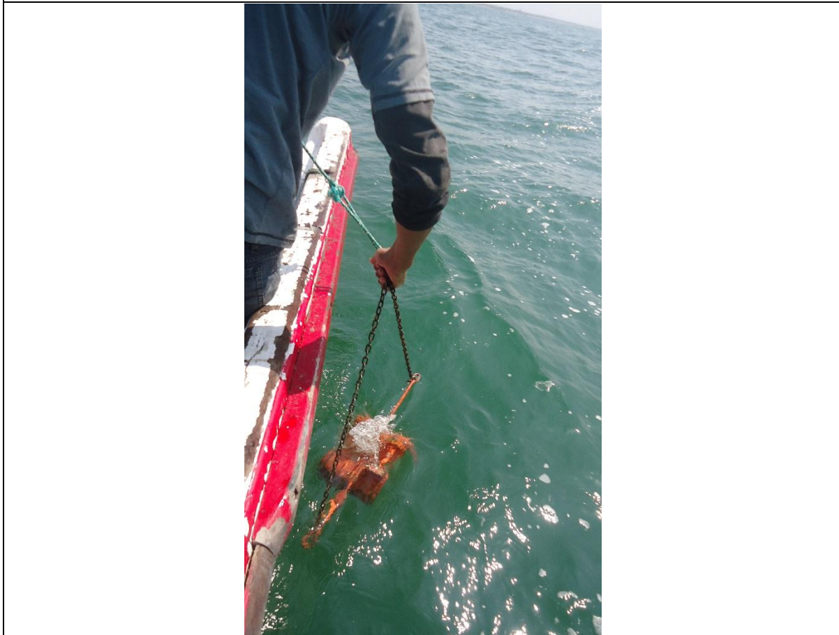
Ingreso de la Draga en Fondo Marino para extracción de muestras de sedimento desde la Boya de Mar a la Boya 13
