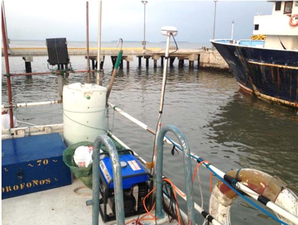
Fotografía 3. Antena DGPS instalada en la cubierta superior de la embarcación
