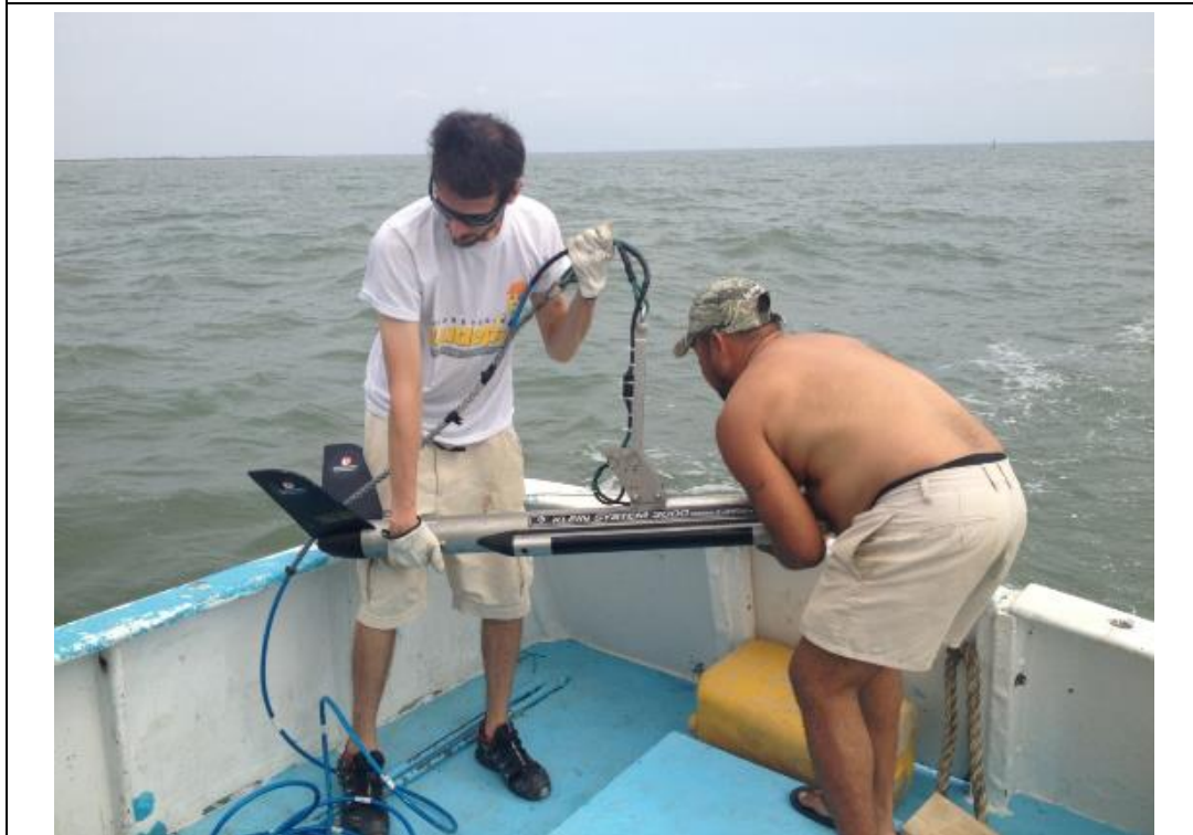
Fotografía 6. Maniobra de introducción de sonar de barrido lateral en el agua
