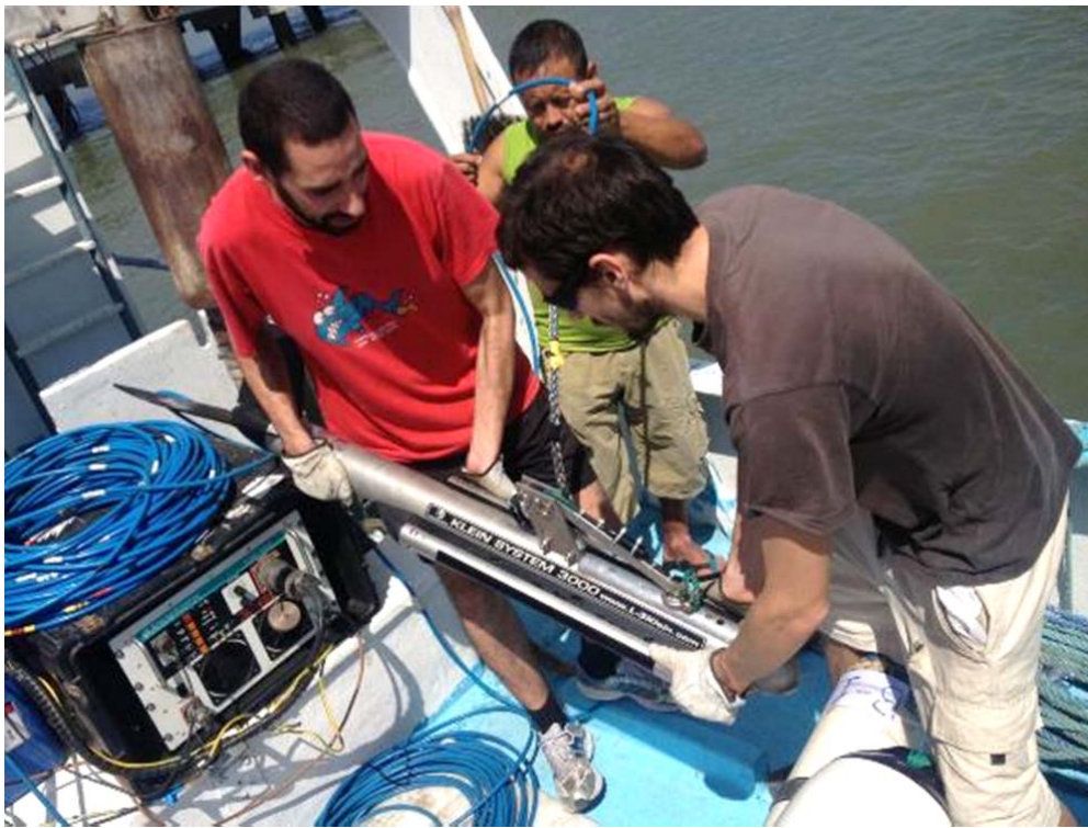
Fotografía 8. Calibración del sonar de barrido lateral
