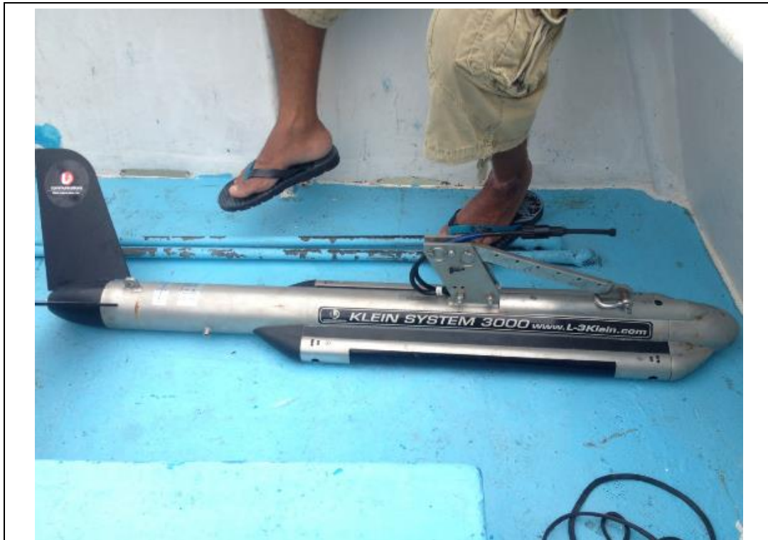
Fotografía 5. Sonar de barrido lateral KLEIN 3000
