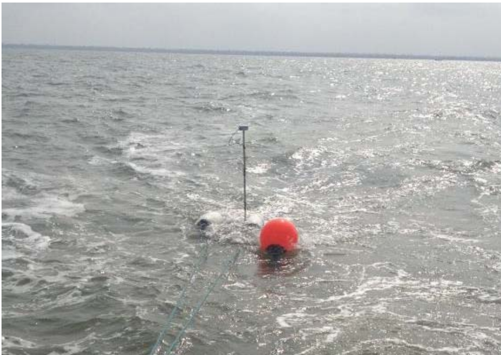
Fotografía 4. Antena DGPS instalada en boomer
