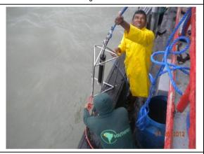
Fotografía N°33: Perfilador ADCP Aquadopp
