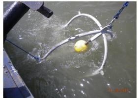
Fotografía N° 13: Correntómetro sumergido en la estación 8
