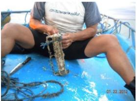
Fotografía N°56: Mareógrafo RBR retirado de la rejilla de protección
