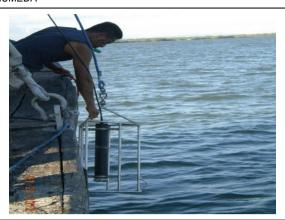
Fotografía N°44: Alce del ADCP para el traslado hacia otra estación
