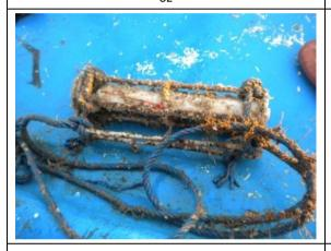
Fotografía N°55: Mareógrafo RBR 2050 retirado
