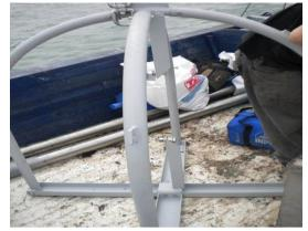
Fotografía N° 1: Estructura de acero del correntómetro S4A
