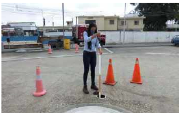
Fotografía 17-18: Verificación de producto en fase libre en dos pozos de monitoreo distintos. Se observa producto en fase libre.
