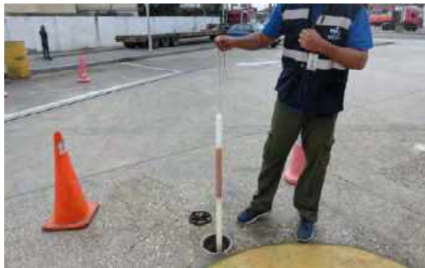
Fotografía 15-16: Verificación de producto en fase libre en dos pozos de monitoreo distintos. Se observa producto en fase libre.
