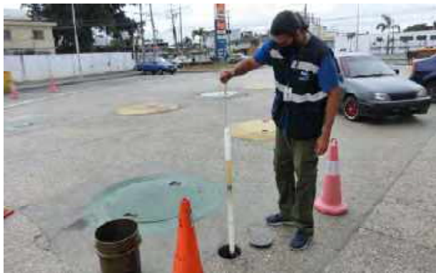
Fotografía 15-16: Verificación de producto en fase libre en dos pozos de monitoreo distintos. Se observa producto en fase libre.
