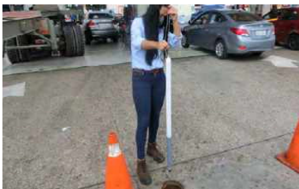
Fotografía 17-18: Verificación de producto en fase libre en dos pozos de monitoreo distintos. Se observa producto en fase libre.
