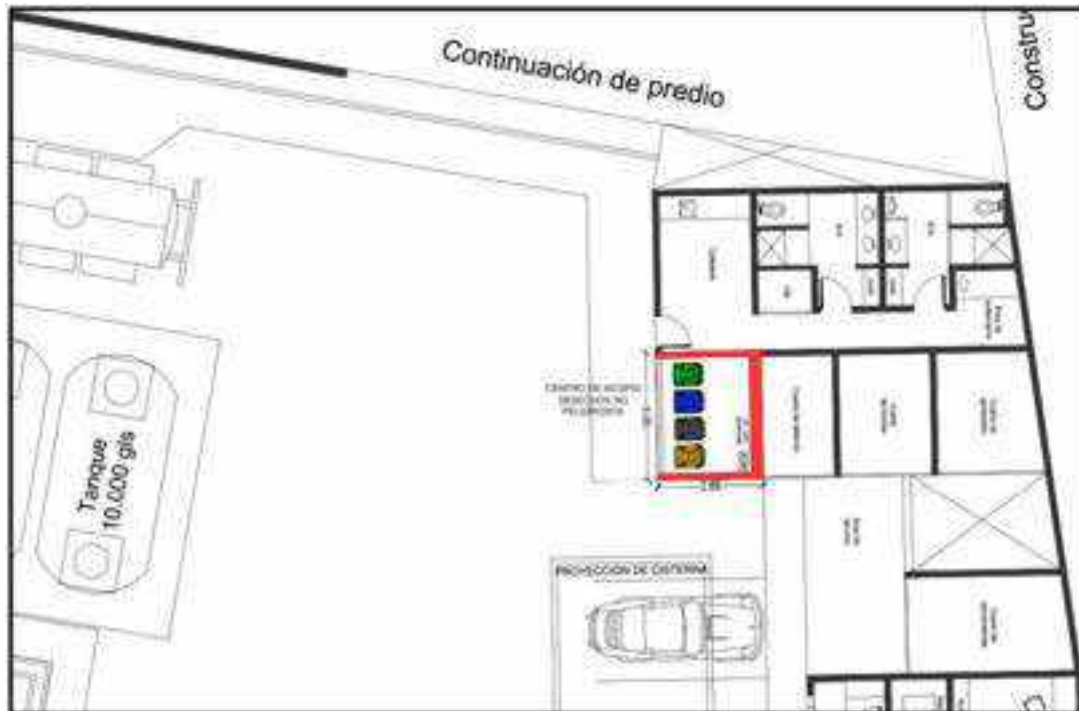
Gráfico 58: Ubicación del centro de acopio de desechos no peligrosos en las instalaciones de la estación de servicio "SAN SEBAS".
