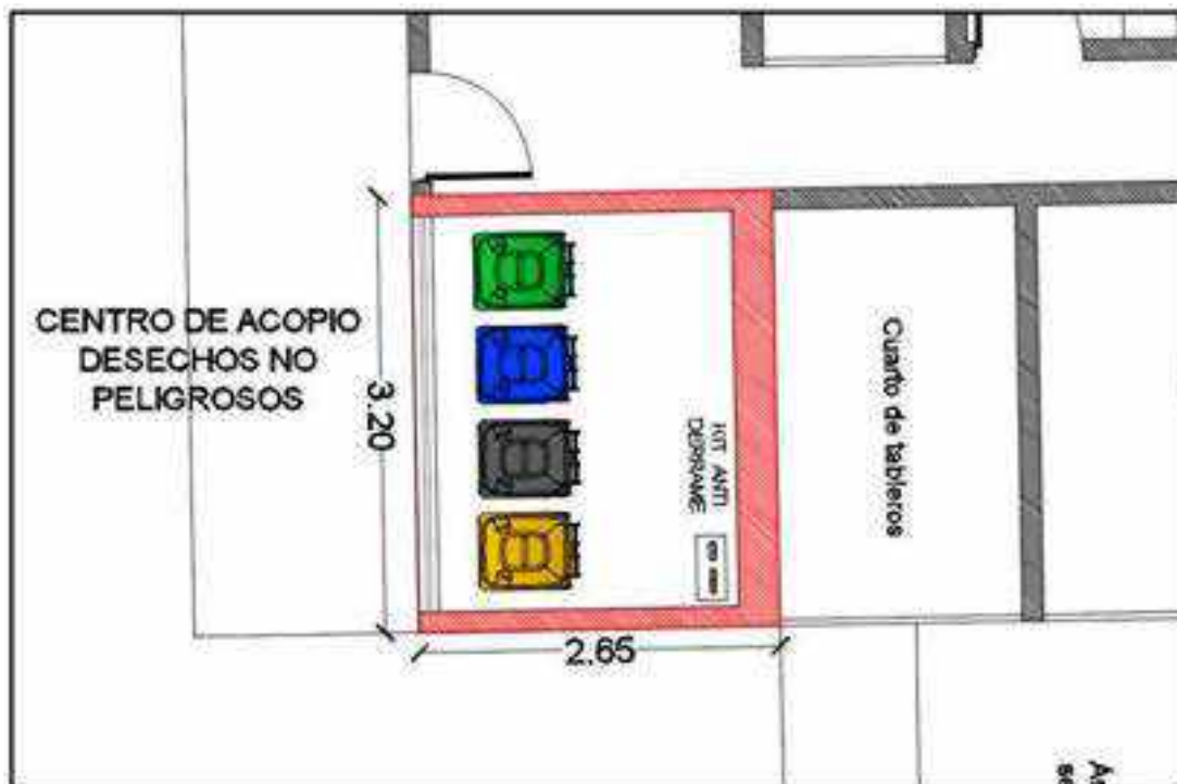
Gráfico 59: Detalle de distribución del centro de acopio de desechos no peligrosos en las instalaciones de la estación de servicio "SAN SEBAS".
